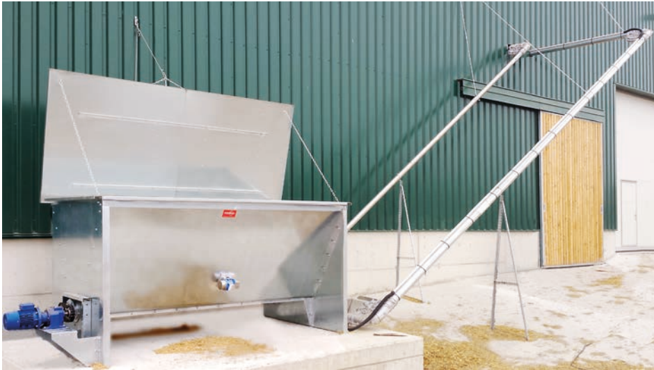
Einstreusystem KFS 100 außerhalb des Stalls
