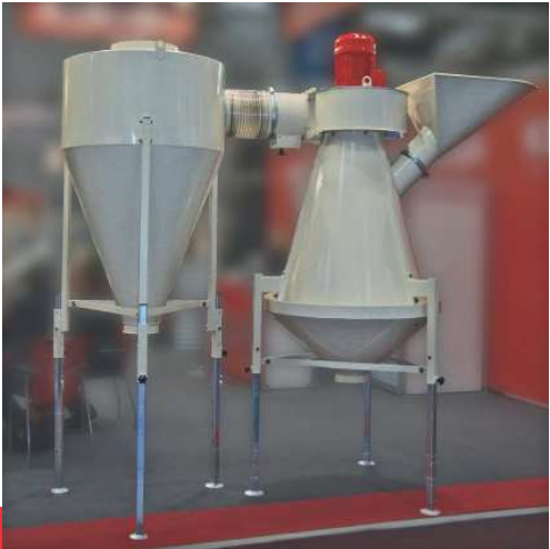
Vorreiniger mit kraftvollem Gebläse für sehr gute und hohe Reinigungsleistung
