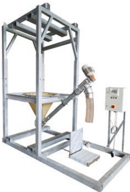
Station auf Rahmen mit Stapleraufnahme, Dosierschnecke \varnothing 100 , Absackwaage und Elektrosteuerung
