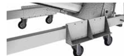
Lenkrollen im Einlaufbereich
