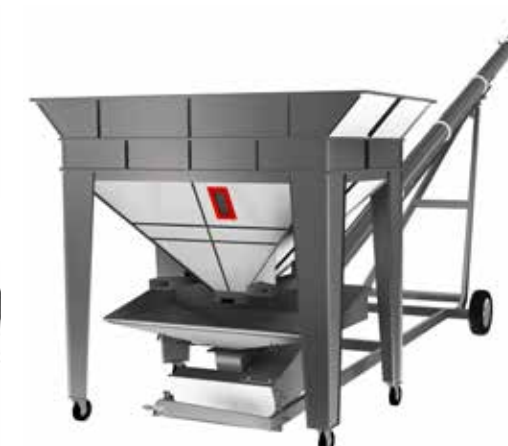
Kombination mit mobilem Annahemtrichter
