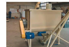
Mieszalnik poziomy z doprowadzonym i oprowadzonym ślimakiem
